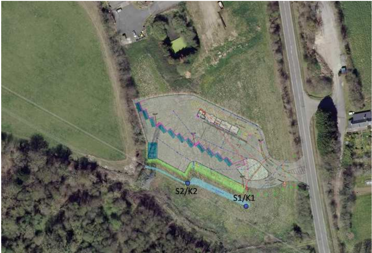
Localisation des sondages et mesures d'infiltration
